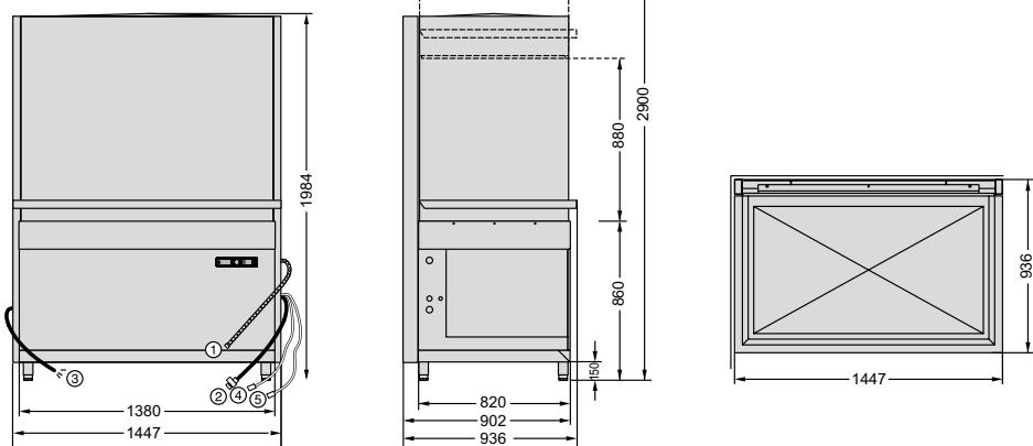
① Odtoková hadice   ② Přípojka čisté vody   ③ Připojovací kabel   ④ Tekutý čisticí přípravek <sup>a)</sup>   ⑤ Lešticí přípravek <sup>a)</sup>
