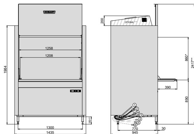
① Odtoková hadice   ② Přípojka čisté vody   ③ samostatné plnění nádrže   ④ Připojovací kabel   ⑤ Tekutý čisticí přípravek a)   ⑥ Leštící přípravek a)   ⑦ Tekutý čisticí přípravek a)
